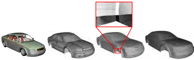
図 2 学習データの準備. (a):元データとなる車のメッシュ. (b):内装・装飾などを取り除いたメッシュ. (c):(b)のメッシュに対して各方向から深度マップを取得し、統合して得られる点群. (d):(c)で得られた点群に対して、Poisson Surface Reconstruction を施し、メッシュを再構成する. その後、約 100000 頂点となるようにメッシュの単純化を施す.
