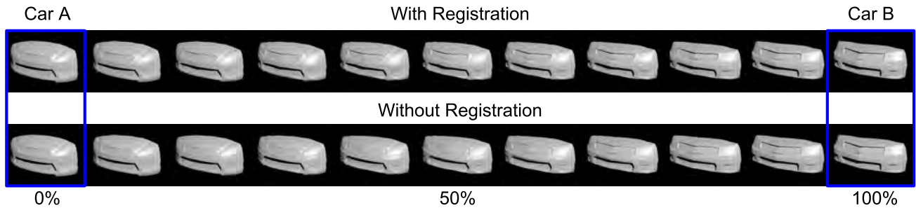
図 7 2 台の車の中間形状の推移. 位置合わせありのモデルから得られる中間形状は, エッジの移動として現れるのに対し, 位置合わせなしのモデルから得られる中間形状は, 2 つの車のエッジの重ね合わせとして現れる.
